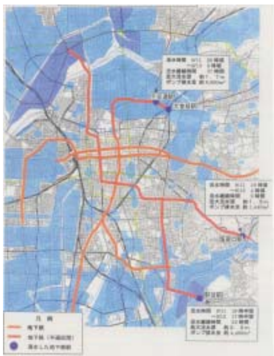
図 1-11 東海豪雨時の地下鉄の不通区間と浸水した駅（出典：国土交通省）
